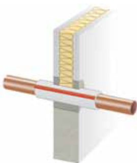
Montage in Massiv- und Leichtbauwand
