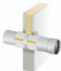
Montage in Massivwand und Leichtbauwand
